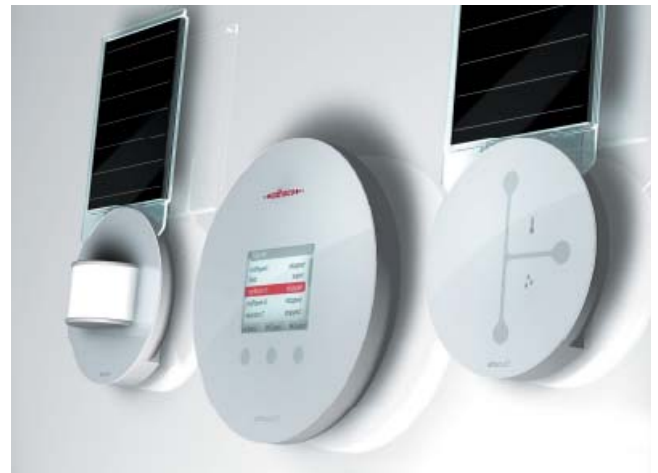
Zentrale mit Präsenzmelder (links) und Temperatur- und Feuchtigkeitssensor (rechts). Kabellose Sensoren mit optionalen Indoor-Solarzellen.
